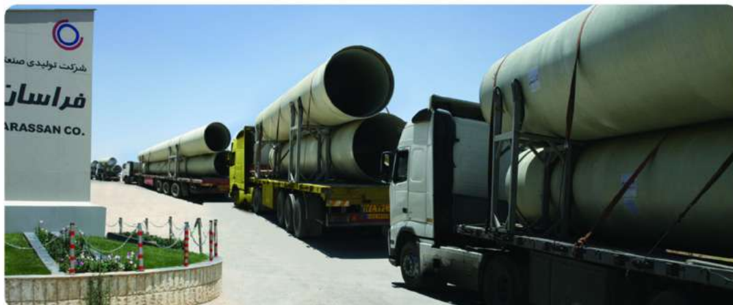
شکل ۷ - نحوه حمل لوله روی سائپورت های پله ای
