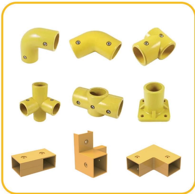
اتصالات هندریل از جنس FRP ، انتخاب ایده آلی برای اتصال و ایمن سازی هستند که دارای زوایای مختلف و از ویژگی های وزن پایین ، مقاومت در برابر خوردگی و آتش ، عایق الکتریسیته ، هزینه تعمیر و نگهداری کم برخوردار می باشند. این اتصالات به روش BMC / SMC و در دو نوع دایره ای و مربعی شکل تولید می شوند.
