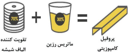
پلاستیک تقویت شده با فایبرگلاس (GRP) یک ماده کامپوزیتی است که تقویت کننده یا الیاف شیشه تو سط یک ماتریس رزین ترکیب می شود تا محصولی با خواص مکانیکی بهتر به دست آید.
