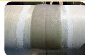
Hand lay-up (Couche appliquées manuellement), Butt - Wrap (Bout à bout-emballage).
