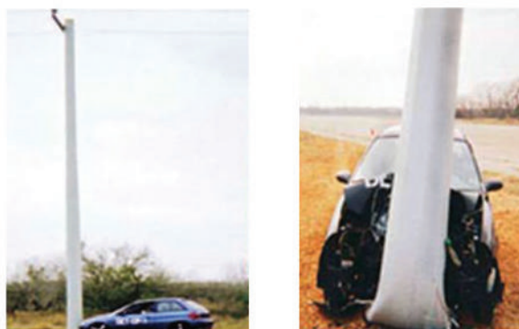
پایه های فلزی یا بتنی غیر ایمن
